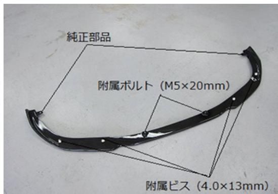
付属部品、純正部品等の取り付け箇所です。仮合わせの際に純正風切モールを一度取り外して下さい。作業は2名以上で行いボディにキズが付かない様に注意して下さい。
