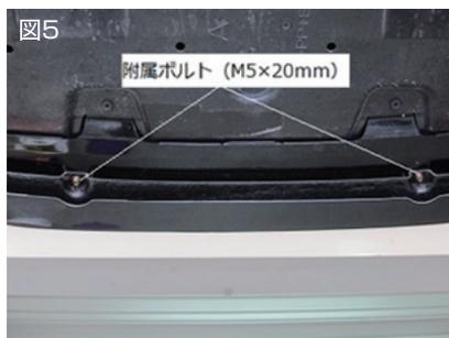
1. 仮合わせの際、干渉部分がある場合、無理に組まないで下さい。車輛との合わせ面をやすり等で調整しながらスポイラーを仮合わせして下さい。各部の取り付け箇所①にならい取り付け位置が決まったら5mmのドリル刃で、純正バンパーに穴を開けて下さい(図1参照)
