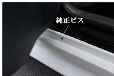
3. サイドステップ上部のフロント側、リア側2ヶ所に純正ビスを使用して正確に固定して下さい。
