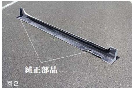
1. ノーマルサイドステップを取り外して下さい。エアロサイドステップを仮合わせをし、全ての箇所を純正ビスを使用して正確に仮止めしてください。仮り合わせの際、干渉する所がある場合は無理に組まず干渉部をやすり等で調整して下さい。
