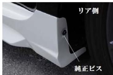
2. サイドステップリア側のフェンダー内側に純正ビスを使用し1ヶ所ボディー側に正確に固定して下さい。フェンダーとの当たり面より少し前側の下側に純正ピン(大)を使用して正確に固定して下さい。
