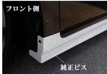
1. サイドステップフロント側のフェンダー内側に純正ビスを使用して1ヶ所、ボディー側に正確に固定して下さい。フェンダーとの当たり面の下側に純正ピン(大)を使用して正確に固定して下さい。
