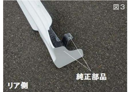
1. エアロサイドステップを仮合わせをし、全ての箇所(図1,2,3)を純正部品を使用して仮合わせをして下さい。
