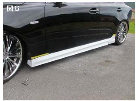
1. 全体のバランスを見て純正ビス・クリップを使用して仮止め部分を正確に固定して下さい。
