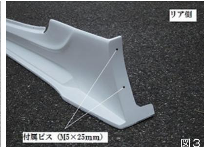
1.サイドステップを仮合わせをし、車両との合いを確認してから、全ての取り付け部分を付属部品を使用して正確に固定して下さい。
