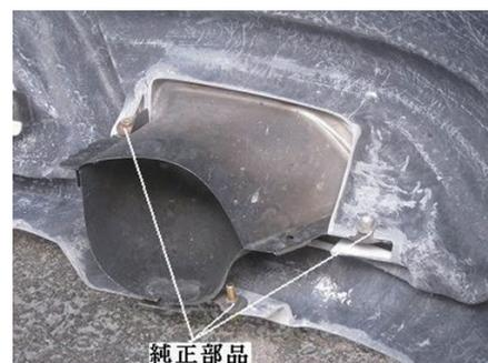
純正のマフラーフィニッシャーをバンパーの内側から仮合わせをし、バンパーの正面から見てフィニッシャーの合いを確認して純正のボルトを使用して正確に固定して下さい。(3ヶ所) この時けがきの部分に純正クリアランスソナーを固定して下さい。
